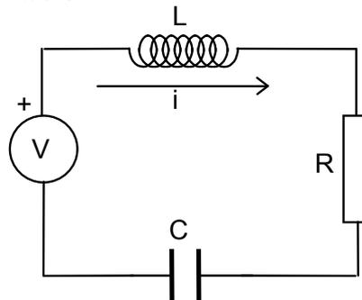
Luego el aplicar una tensión V al circuito sería equivalente a aplicar una fuerza F al sistema mecánico. Entonces la intensidad i que circularía por el circuito sería análoga a la velocidad que adquiriría la masa y la carga al desplazamiento de la masa.
