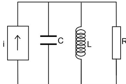
En este caso, la intensidad de la fuente es análoga a la fuerza aplicada, la tensión a la velocidad de la masa y el flujo al desplazamiento. De esta forma, no es necesario construir el sistema mecánico para observar su funcionamiento, sino que basta con realizar su circuito eléctrico equivalente. La ventaja de utilizar esta analogía es aún más relevante cuando se desea observar el funcionamiento del sistema mecánico con diferentes masas, rozamientos, etc.
