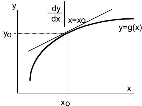
Gráficamente, para un sistema con una variable de entrada y una variable de salida, se puede ver como la sustitución de la curva que representa la relación entre ambas variables por la tangente a dicha curva en el punto de funcionamiento deseado. En este caso para pequeñas variaciones de dichas variables, la diferencia entre la curva y la tangente es también pequeña.
