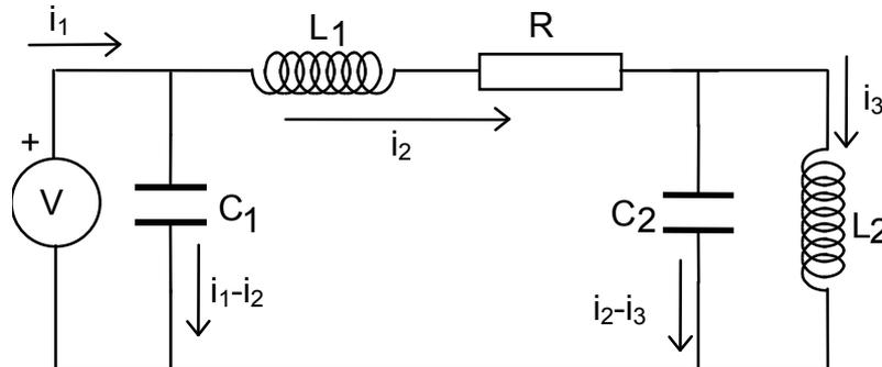
Luego la tensión V aplicada al circuito sería equivalente al par T aplicado al sistema mecánico, las intensidades  $i_1$  e  $i_2$  sería análogas a la velocidades que adquirirían la masas y las cargas al desplazamiento de la masas.
