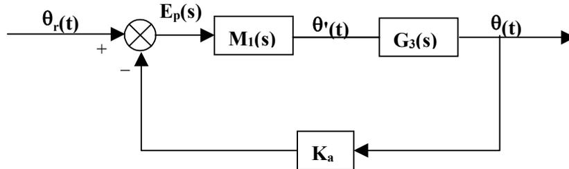
No se conoce la función de transferencia de  $G_3(s)$ . Pero en el diagrama de bloques del enunciado puede verse que la entrada de dicho bloque es la derivada de  $\theta(t)$  y la respuesta es la propia  $\theta(t)$ , luego el bloque será un elemento integrador, por lo que se tiene:
