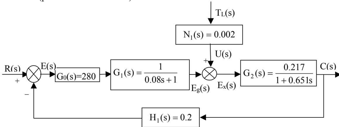
1. Calcular el error  $E(s)$  que tendrá la antena, en estado estacionario, si ambas entradas,  $R(s)$  y  $T_L(s)$  son un escalón unitario.
