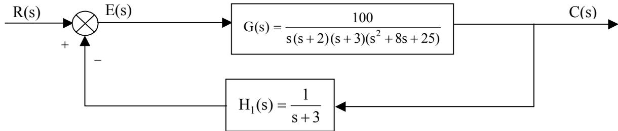
Calcular el error en régimen permanente ante una entrada escalón unitario y el error en régimen permanente ante una entrada en rampa unitaria.
