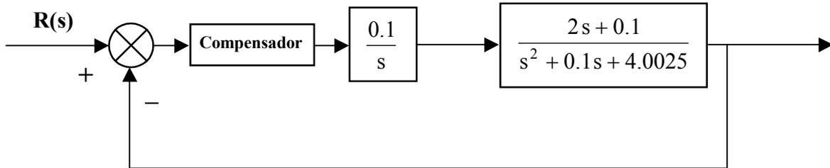
Calcular el compensador necesario para que el sistema ante la entrada  $r(t) = 2t + 4.0025$  tenga un error en régimen permanente de 80.05.
