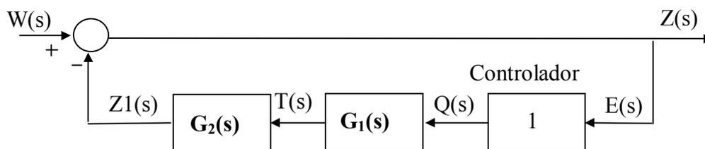
Se comprueba cómo la señal de error del sistema original es igual, cuando  $Z_{ref}=0$ , a la salida del sistema y al error del diagrama de bloques anterior (señal de error de perturbación). Luego, el valor en estado estacionario de la señal de error original debido a la perturbación, se puede calcular de varias formas, una de ellas es la siguiente:
