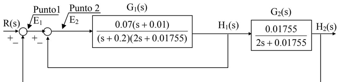
Calcular los errores que se producen en los puntos 1 y 2 en régimen permanente, cuando a la entrada  $R(s)$  se introduce una entrada escalón de amplitud 2.
