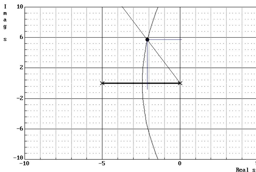
Trazando la recta a  $69.64^\circ$  se observa que el punto de corte esta en torno a  $P=-2.1+j5.75$
