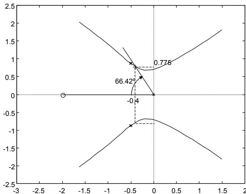
Trazando una recta con  $66.42^\circ$  el punto de corte con el lugar de las raíces corresponde con:
