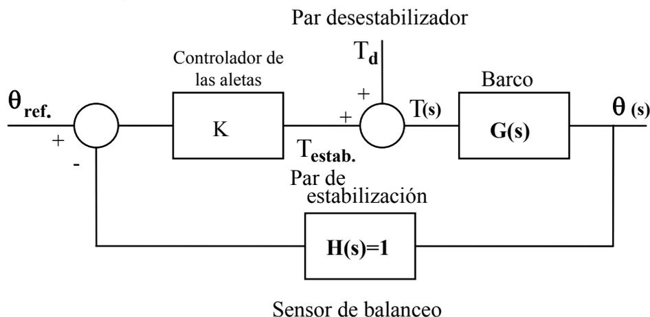
Por otro lado, el movimiento de balanceo del barco puede considerarse como un péndulo oscilante con una desviación de  $\theta$  grados en torno a la vertical, de forma que la función de transferencia de la dinámica del barco es de la forma siguiente:
