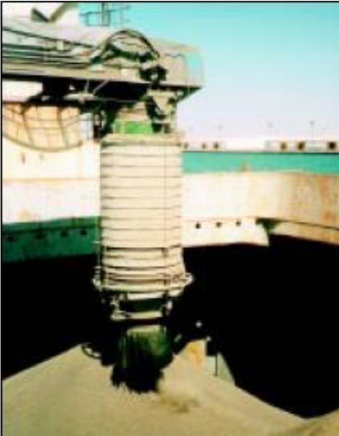
En las fotos tenemos tubos de carga con conos en cascada para controlar la velocidad de caída del granel, para evitar que este se trocee y la formación de polvo.
