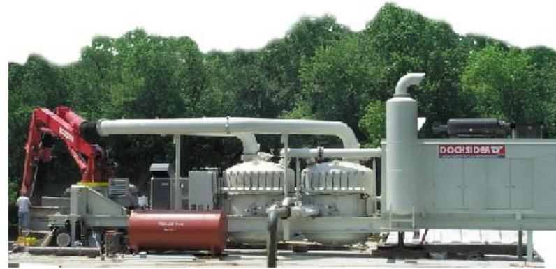
Con mercancías que pueden ser fluidificadas se puede cargar o descargar el buque mediante un sistema neumático y con tuberías flexibles de goma, evitando la transmisión de polvo al medioambiente.
