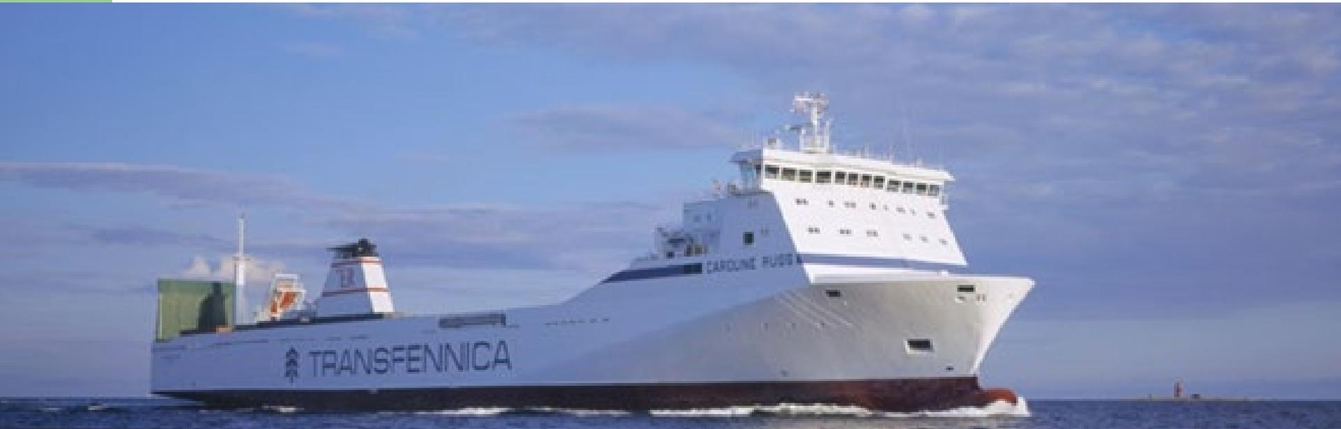
**El buque de transbordo rodado, Roro puro, es empleado en rutas cortas, es considerado así si lleva menos de 12 pasajeros, normalmente los conductores. La carga es embarcada mediante rampas a la altura de la cubierta principal. Las rampas internas permiten el acceso al resto de las cubiertas.**
