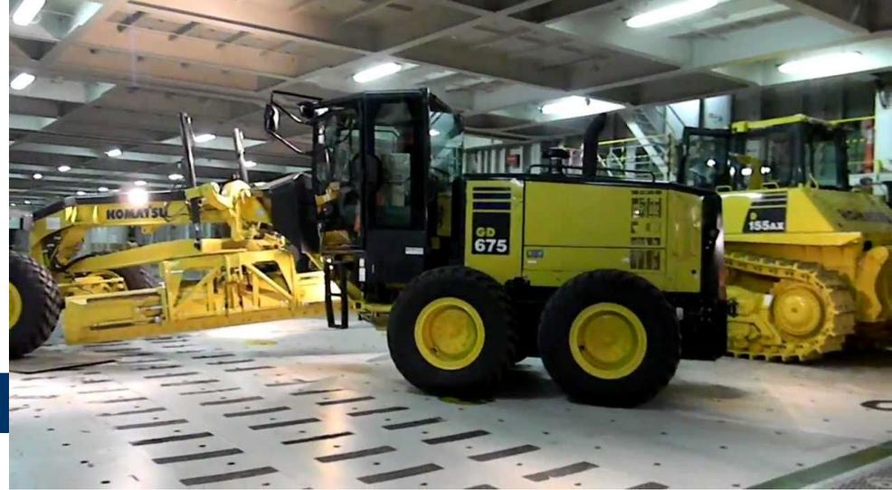
El LCTC (Large Car Truck Carrier) m/v FAUST tiene capacidad para 8.000 coches o 3.484 coches y 468 autobuses en sus 67.300 m<sup>2</sup>. Tiene 13 cubiertas, 5 móviles. Las cubiertas 1, 3, 5 y 8 están reforzadas para poder transportar cargas pesadas. Las cubiertas 2, 4, 6, 7 y 9 están divididas en secciones regulables en altura. Estas secciones de las cubiertas se izan o arrían mediante un elevador móvil.
