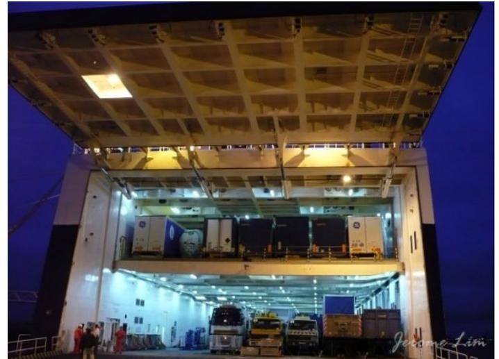
Los cocheros puros (PCC) están específicamente diseñados para el transporte de automóviles y cargas ligeras similares, tan eficientemente como sea posible. Pueden tener hasta 13 cubiertas para automóviles, donde 2 de ellos, al menos, son ajustables en altura. Este tipo de buque es, por lo general, el más pequeño de los diseños RoRo, y típicamente tienen una eslora de 200 metros. La capacidad de carga para un PCC oscila entre 1 000 - 6 500 RT43 o CEU.
