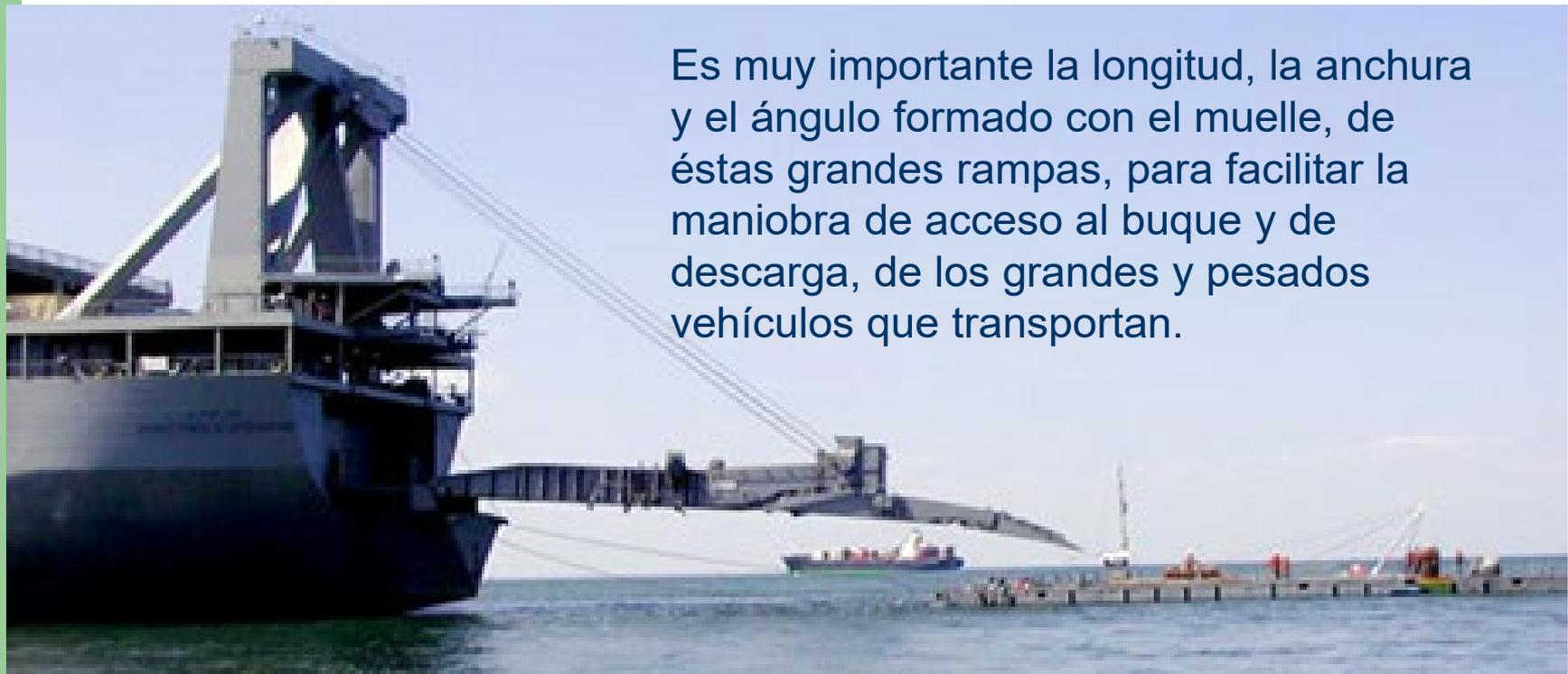
Es muy importante la longitud, la anchura y el ángulo formado con el muelle, de éstas grandes rampas, para facilitar la maniobra de acceso al buque y de descarga, de los grandes y pesados vehículos que transportan.
