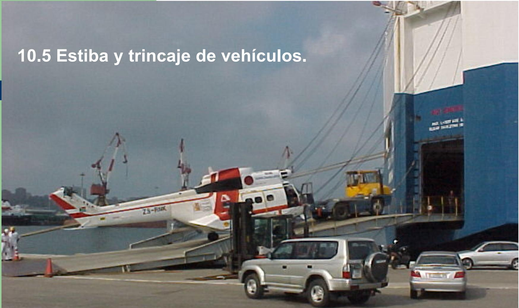
Los vehículos se estibarán longitudinalmente, con espacio entre ellos para inspeccionarlos, y debidamente trincados.
