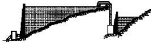
Figura 3.4. Esquema simplificado de una central mixta de acumulación por bombeo. [Ángel Luis Orille Fernández, Centrales Eléctricas I]
