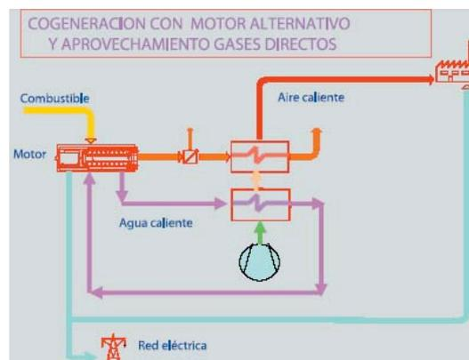
Figura 4.56. Diagrama de proceso de planta de cogeneración con motor de gas, para generación de aire caliente. [Guía de la cogeneración]
