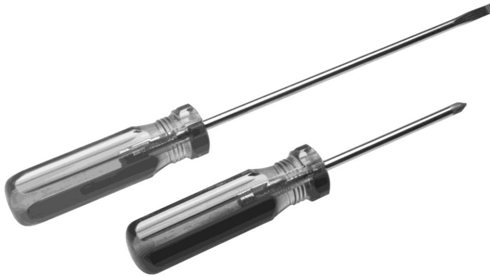
Destornilladores típicos, con varilla de acero y mango de polímero (plástico).
