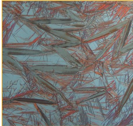
Solución sólida sobresaturada de C en  $Fe_\alpha$  obtenida por enfriamiento muy rápido. Es el constituyente más duro de los aceros tras la cementita.
