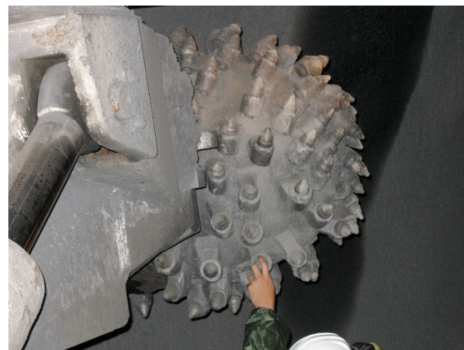
Picas en una cabeza de tipo Ripping de un minador. «Minador Moderno». Silvia Alba. https://www.flickr.com/photos/barrenera . https://flic.kr/p/6rz7Kb . https://creativecommons.org/licenses/by/2.0/ .
