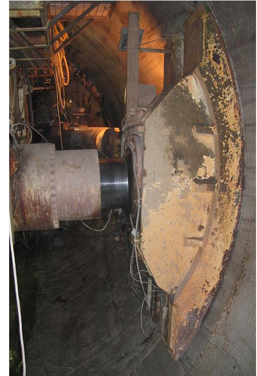
«Hydraulic jacks holding a TBM in place».
