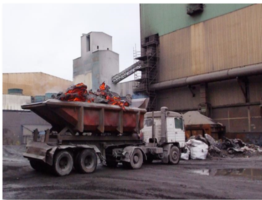
Transporte de las escorias tras ser retirada del horno
