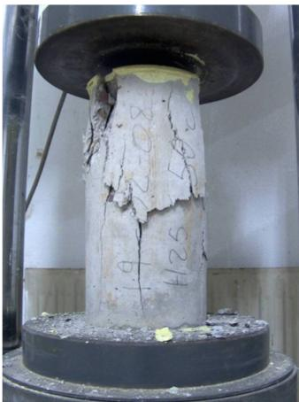
*Probetas normalizadas de hormigón refrentadas (arriba) y ensayada a compresión (izquierda).*
