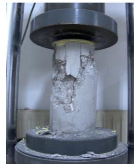
En los ensayos de **resistencia a compresión** se van a emplear un mínimo de **5 probetas** cilíndricas normalizadas.
