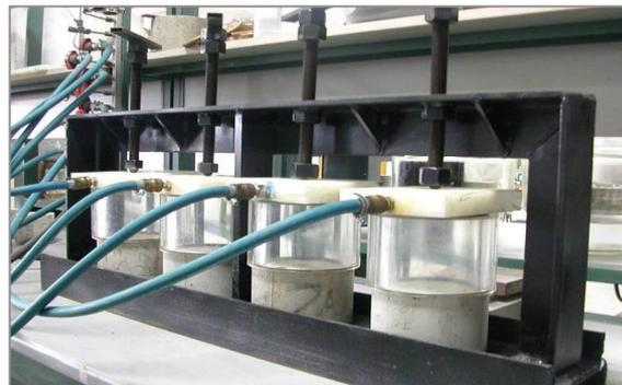
*Dispositivo experimental para los ensayos de penetración de agua bajo presión.*
