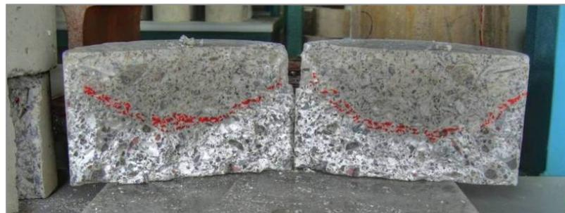
*Perfil de profundización del agua en los ensayos de penetración de agua bajo presión.*
