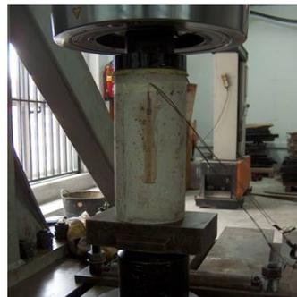
*Fotografía de una probeta instrumentada con galgas extensométricas y colocada entre los platos de la prensa para el ensayo.*
