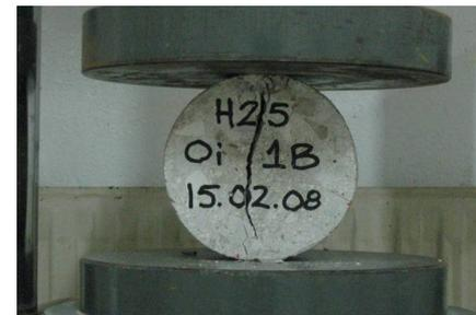
*Esquema de fuerzas (izquierda) y tercio de probeta cilíndrica ensayada (derecha) a tracción indirecta.*
