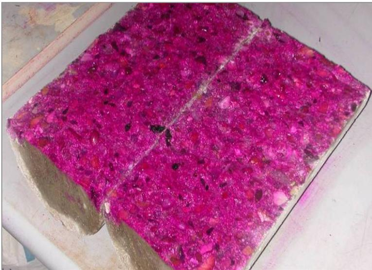
*Superficie interior de una probeta normalizada de hormigón, rota por tracción indirecta, a la que se ha aplicado una fina capa de fenolftaleína.*
