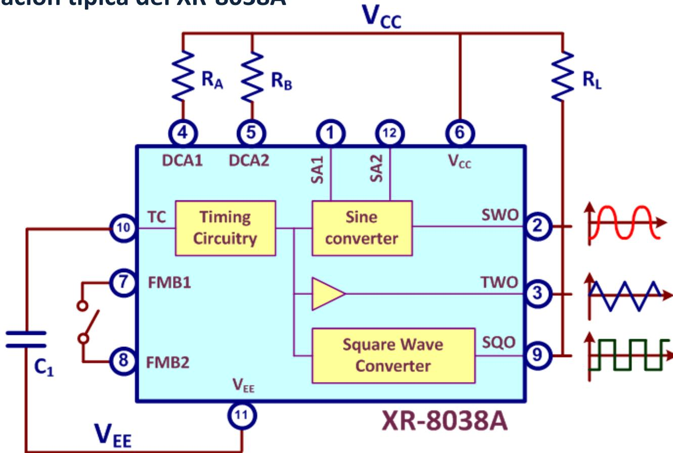
➤ **Frecuencia de las señales de salida:**
