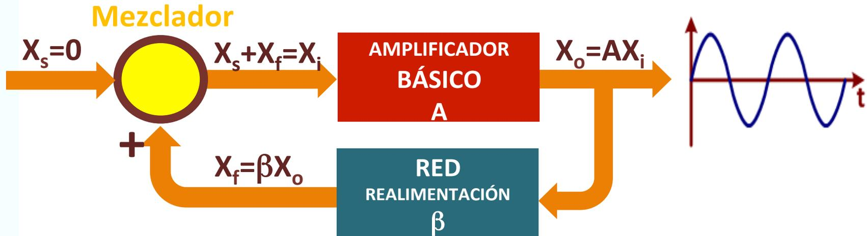
**ESTRUCTURA BÁSICA DE UN OSCILADOR SINUSOIDAL**
