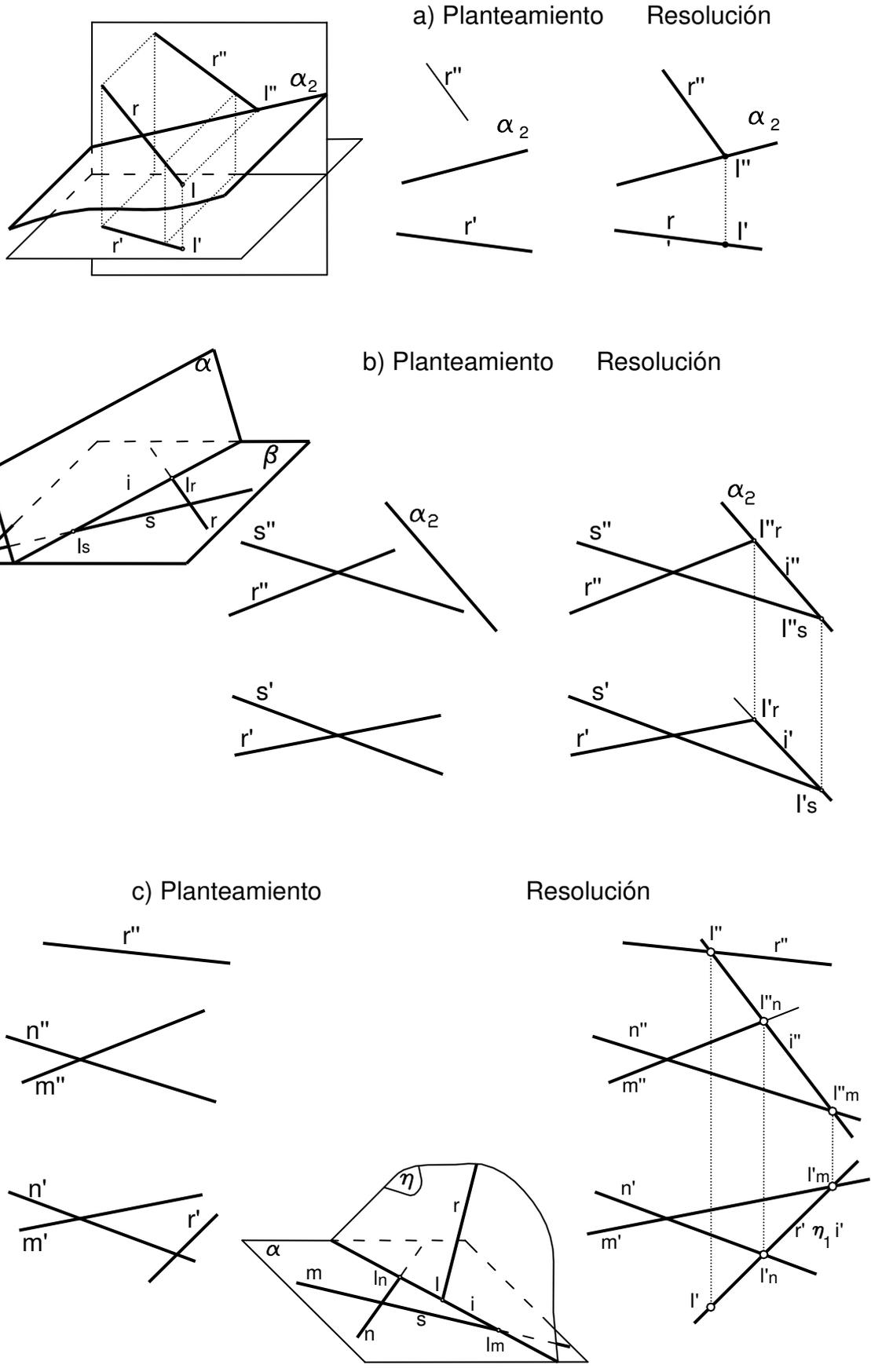
Figura 2. Intersecciones: recta - plano y plano - plano.
