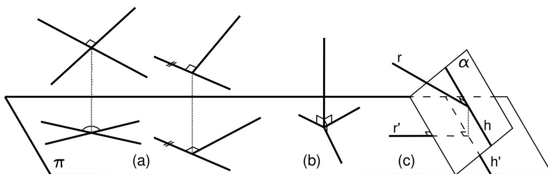
Figura 4: Perpendicularidad en la proyección paralela.
