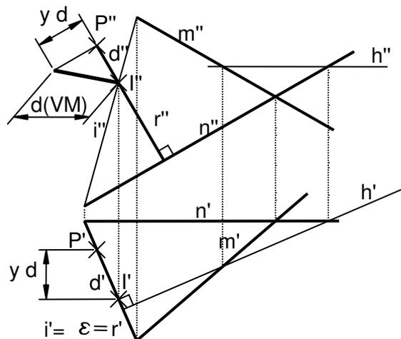
Figura 5: Distancia punto – plano, en geometría del espacio y en S. Diédrico.
