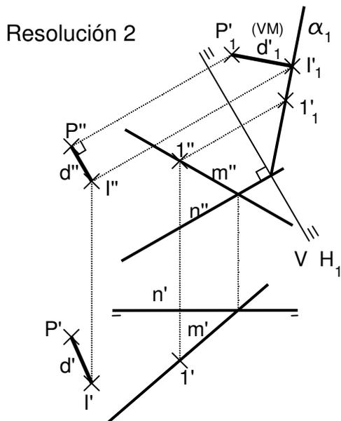
De los métodos que hay para resolverlo, se muestran dos. En la figura 5 se resuelve siguiendo los pasos detallados en el croquis. Y en la figura 6 se plantea su resolución mediante cambio de plano, en el que se sitúa  $\alpha(m,n)$  como proyectante, de este modo la mínima distancia aparece en verdadera magnitud.
