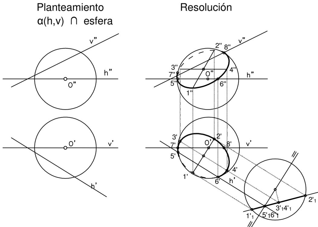
Figura 7: Obtención de  $\alpha(h,v) \cap$  esfera.
