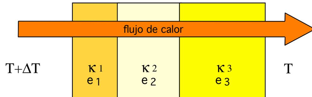
El flujo de calor disminuye introduciendo una capa intermedia de alta resistencia térmica (  $R = e/\kappa A$  )
