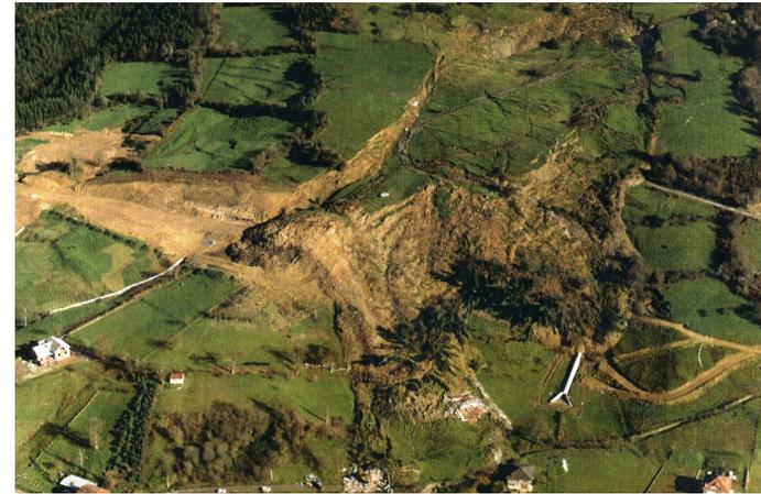
Gran deslizamiento de una ladera por excavación al pie.
