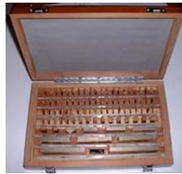
**PATRÓN:** es un objeto, fenómeno o experimento que materializa, con elevada precisión y estabilidad, un valor (o varios) de una determinada magnitud física.
