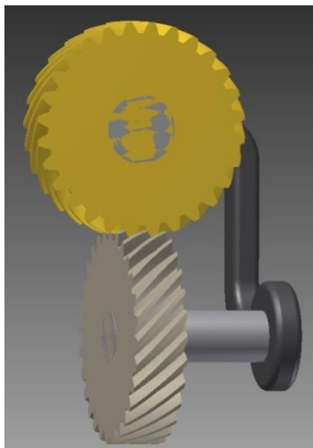
Figura 5. Engranaje helicoidal y de cremallera, ambos con ejes a 90°.
