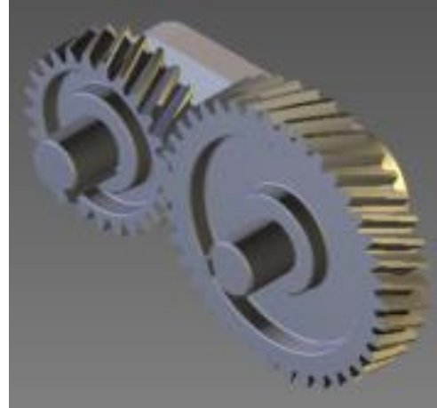
Figura 3. Engranajes cilíndricos, con dentado recto y helicoidal.
