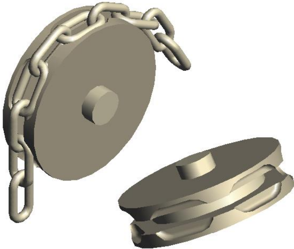
Figura 35. Cadenas de eslabones y polea.
