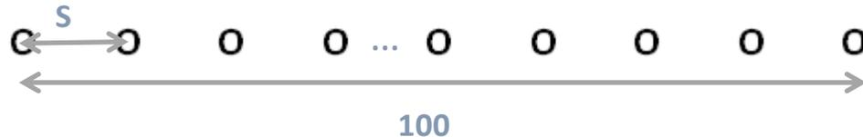
$$n_{\text{BARRENOS}} = \frac{\text{longitud}_{\text{frente}}}{\text{espaciamiento}} + 1 = \frac{100\text{m}}{0,75} + 1 = 134\text{barrenos}$$
