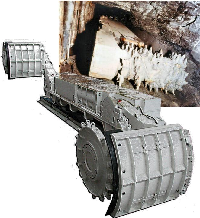
❁ **ROZADORAS:** Máquina más frecuentemente empleada en tajo largo. Existen tres tipos: **doble tambor articulado\*** (la más usada, permite corte en dos direcciones), tambor simple articulado, tambor simple fijo.
