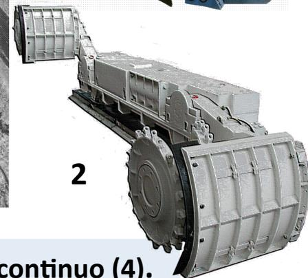
**VARIANTE: Tajo corto. Ancho de panel inferior a 100 m. Trabajo con minador continuo (4).**
