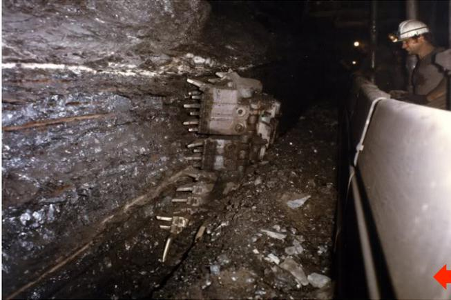
❁ **CEPILLOS:** Empleados en capas de baja pendiente con carbón no muy duro y potencia de entre 0,5 y 2 m. Útil de corte con una serie de picas sujeto a 1 ó 2 motores mediante una cadena para desplazarlo sobre el frente del carbón. En muchos casos la longitud del taller supera los 300 m.
