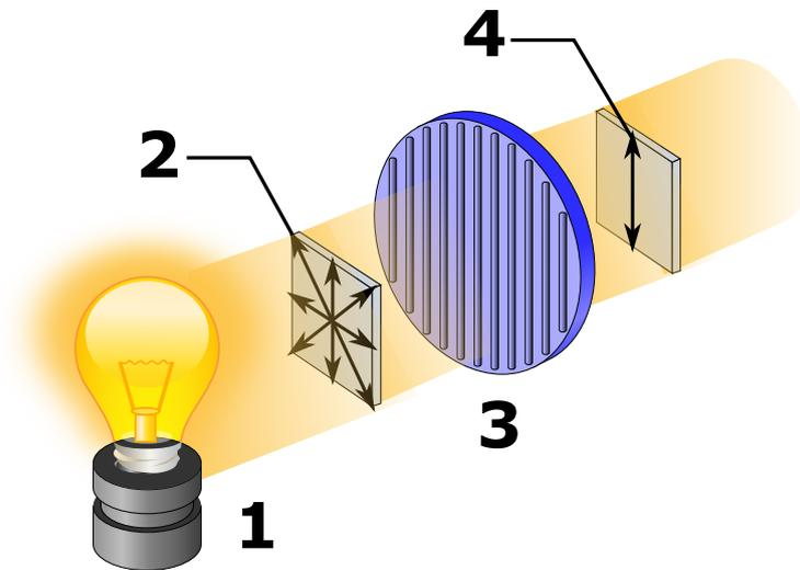
**Figura 14.** Polarización de la luz: uso de un filtro polarizador vertical. Fuente: Wikimedia. Licencia: CC-BY-SA 3.0. <http://bit.ly/2AeYuDN>
