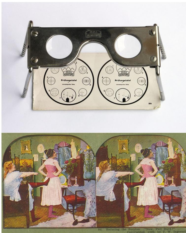
**Figura 15.** Estereoscopio (parte superior) y tarjeta estereoscópica de 1899 (inferior). Fuente: Wikimedia. Licencia: CC-BY-SA 2.5 (superior) <http://bit.ly/2AFqFwL>; Dominio público (inferior) <http://bit.ly/2zNTOWQ>.
