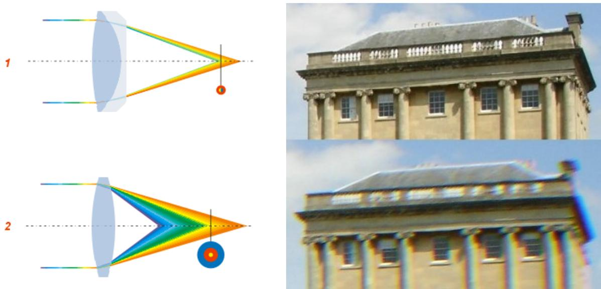
**Figura 26.** Representación esquemática de la aberración cromática (parte izquierda) y ejemplo del efecto en fotografía (parte derecha). Fuente: Wikimedia. Licencia: CC BY-SA 3.0 <http://bit.ly/3qA20jj>
