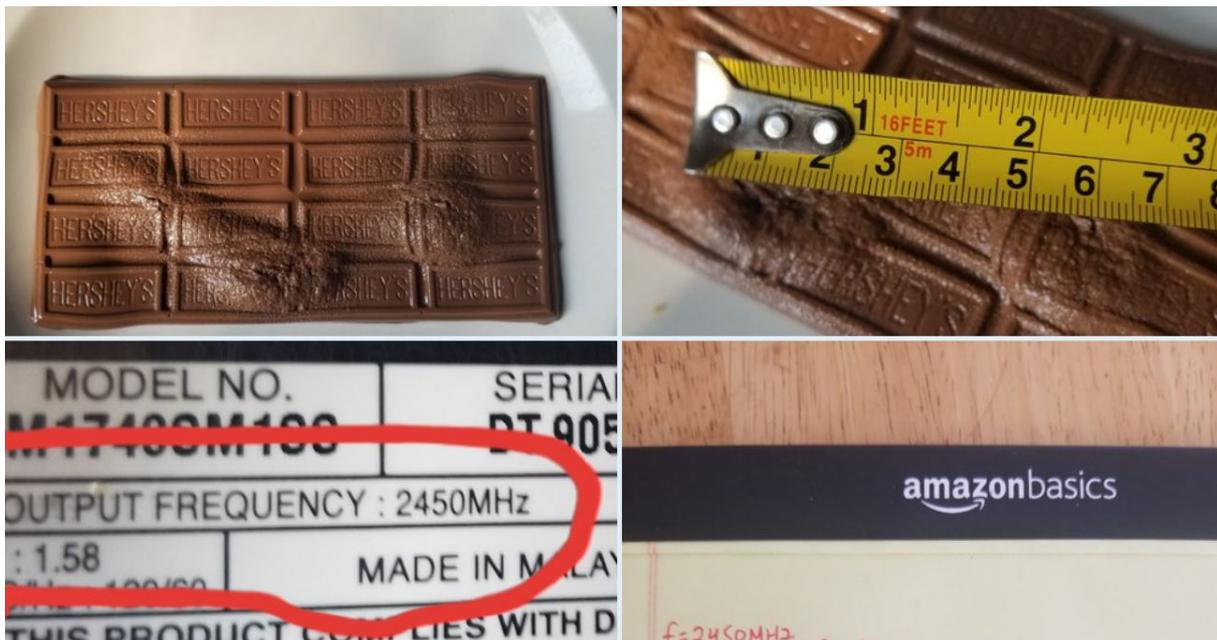
**Figura 7.** Imágenes del proceso para medir la longitud de onda de un microondas. Fuente: David Berardo (@CentriPotential). <https://bit.ly/2XF7UmF>
