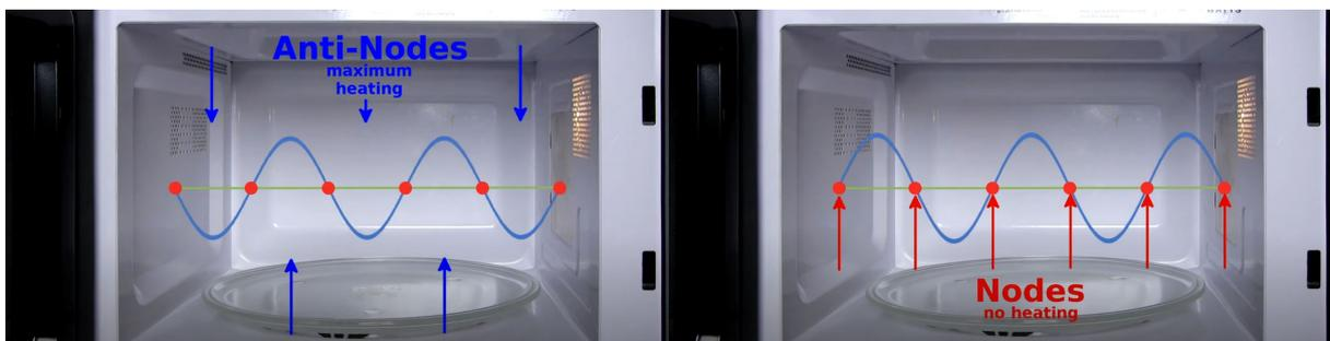
**Figura 6.** Representación esquemática de los “nodos” y “anti-nodos” de las microondas. Fuente: engenerguy. Licencia: YouTube Standard. <https://bit.ly/3qnIhmW>
