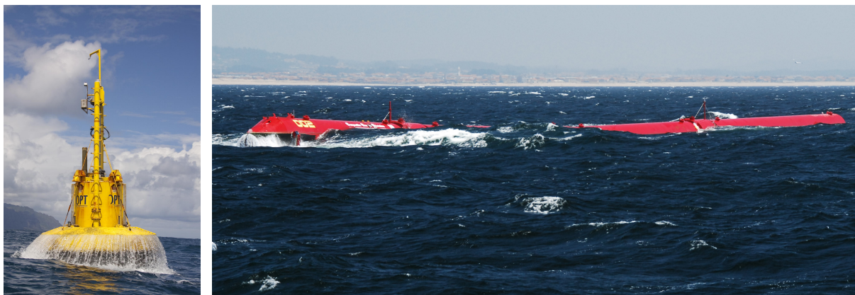
Figura 2.3. Dispositivos para el aprovechamiento de la energía undimotriz (izquierda: PB40 PowerBuoy por Ocean Power Technologies (Licencia: Dominio Público); derecha: sistema Pelamis (Licencia: Dominio Público)).
