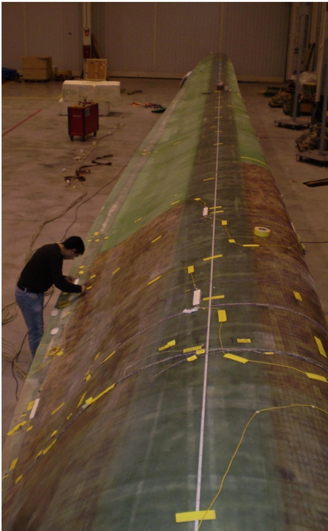
**Figura 5.16.** Instalación de sensores de fibra óptica basados en redes de difracción en la pala de un aerogenerador. Fuente: Grupo de Ingeniería Fotónica de la Universidad de Cantabria.
