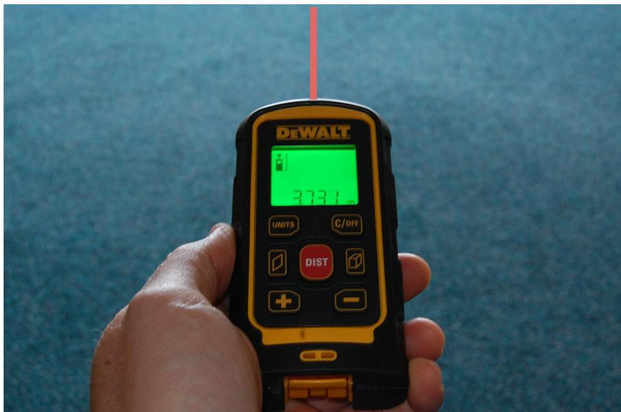
**Figura 5.2.** Medidor de distancia por láser. Fuente: Wikimedia (imagen original modificada). Licencia: CC-BY-SA 2.0. <http://bit.ly/2zrnRjq>
