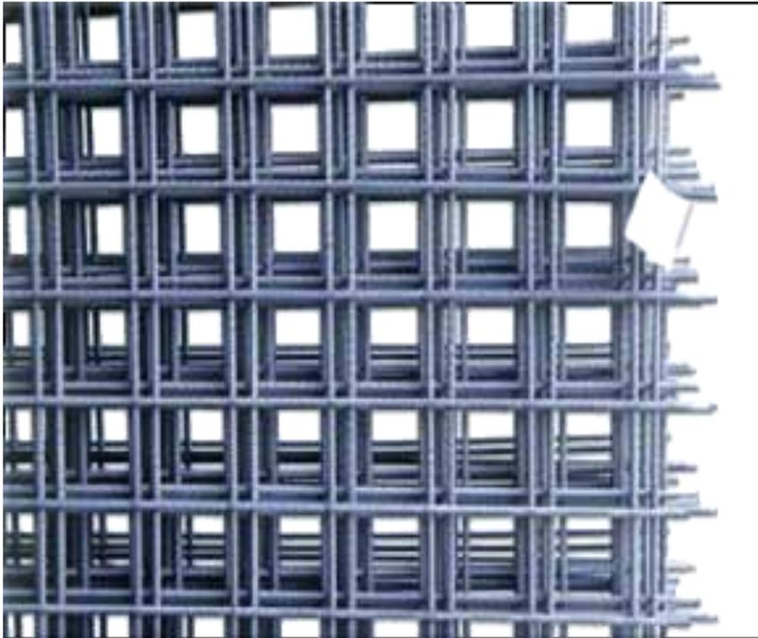
Los diámetros nominales de los alambres corrugados empleados en las mallas electrosoldadas se deben ajustar a la serie siguiente: 5 - 5,5 - 6 - 6,5 - 7 - 7,5 - 8 - 8,5 - 9 - 9,5 - 10 - 10,5 - 11 - 11,5 - 12 y 14 mm
