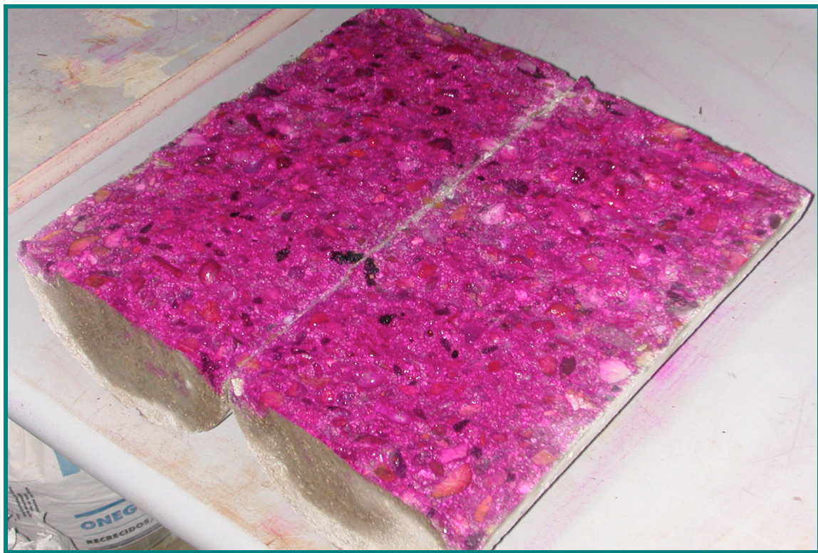
Fig. 6. Superficie interior de una probeta normalizada de hormigón, rota a tracción indirecta, a la que se ha aplicado una fina capa de fenoftaleína.
