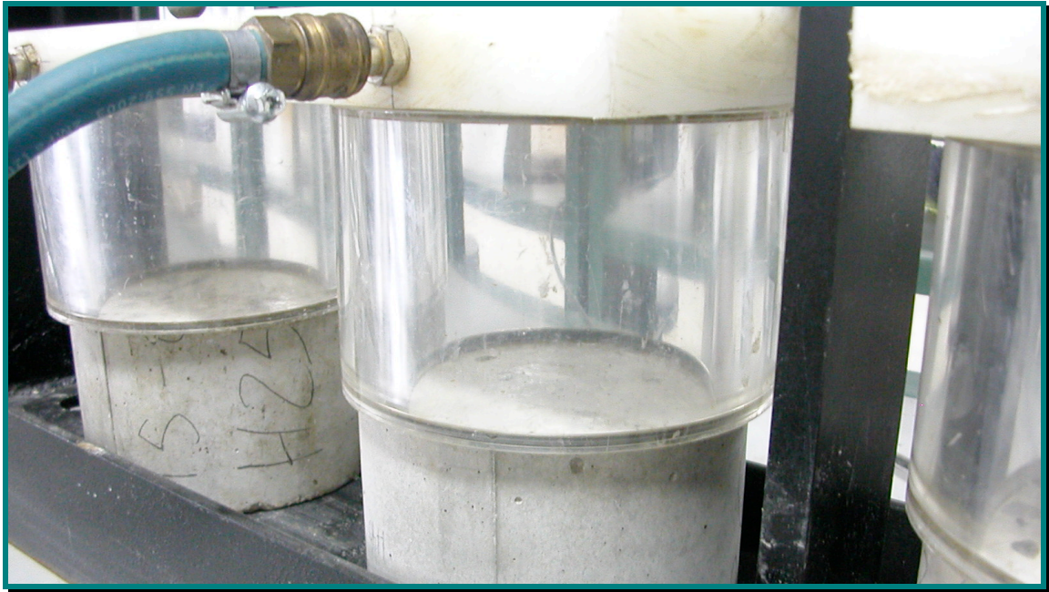
Fig. 3. Detalle del dispositivo experimental para los ensayos de penetración de agua bajo presión.
