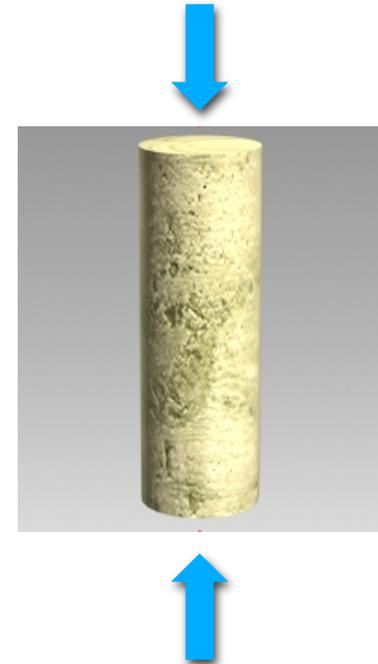
La resistencia a **tracción** y a **compresión** se define por la máxima tensión de tracción o de compresión, respectivamente, que puede soportar el material sin romperse.
