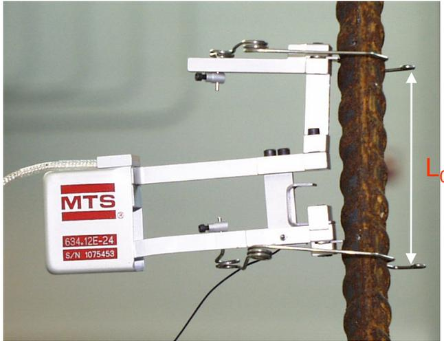
Extensómetro de patillas (con contacto).
