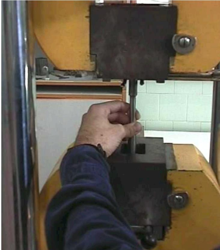
Colocación del **extensómetro**.
