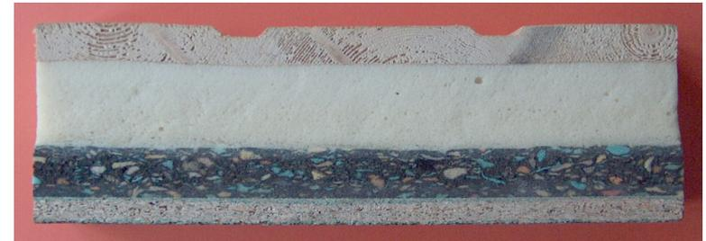
Estructuralmente, el núcleo cumple dos funciones. En primer lugar, separa las caras y resiste la deformación perpendicular al plano de la cara. En segundo lugar, aporta cierto grado de resistencia a cortante a lo largo de los planos perpendiculares a las caras.
