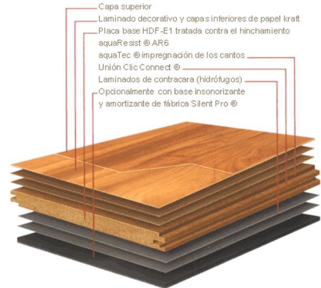
Los paneles sandwich consisten en dos láminas externas fuertes, o **caras**, separadas por una capa de material menos denso, o **núcleo**, que tiene baja rigidez y baja resistencia. Las caras resisten la mayor parte de las cargas en el plano y, también, cualquier esfuerzo de flexión transversal.
