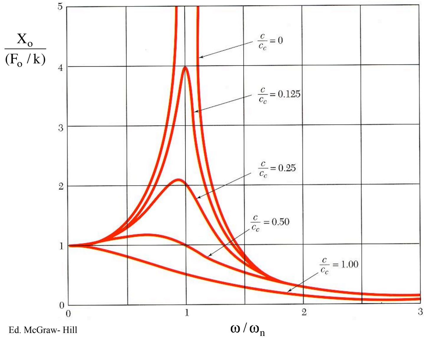
Una vibración forzada puede provenir del **exterior** (por ejemplo, un suelo que se mueva como ocurre en los terremotos) o **interior** como ocurre cuando en una máquina hay una rotación descompensada.
