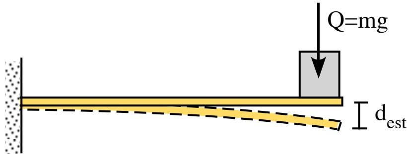
Si la carga  $Q$  ha producido un desplazamiento del punto en que se ha colocado  $d_{est}$  significa que la viga ha respondido con una fuerza recuperadora que la iguala. Podemos calcular entonces la constante recuperadora  $k$ :
