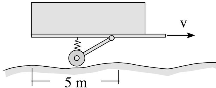
Remolque con dos ruedas y 2 muelles en paralelo, muelle equivalente con  $k_e = 2k$
