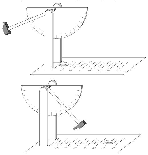
La energía potencial del martillo cuando se desplaza un ángulo  $\boldsymbol{\theta}$  de la vertical y se deja caer, se convierte en energía cinética cuando está en la posición vertical. A través de la expresión de conservación de la energía podemos calcular la velocidad angular  $\boldsymbol{\omega}$  y la velocidad lineal  $\boldsymbol{v}$  del punto del martillo que impacta con el disco, justo antes de la percusión.
