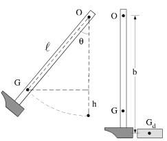
Durante la percusión cambiarán estas velocidades y justo después el martillo tendrá una velocidad angular diferente  $\omega$ '. Ahora la energía cinética que posee el martillo se convertirá nuevamente en la energía potencial que adquiere hasta llegar a un determinado ángulo máximo  $\theta$ ', donde se detiene antes de volver a caer.
