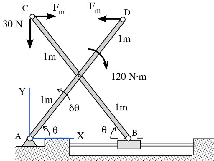
Consideramos el sistema en una posición general, compatible con los enlaces. El muelle se ha sustituido por la fuerza que ejerce en los puntos C y D. Las fuerzas en los enlaces no contribuyen al trabajo. Basta una coordenada para situar el sistema:  $\theta$
