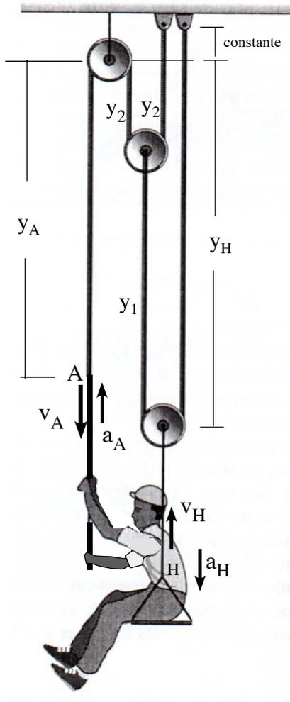
Longitud del hilo desde el punto A hasta el extremo fijado al techo (eliminados los tramos constantes):
