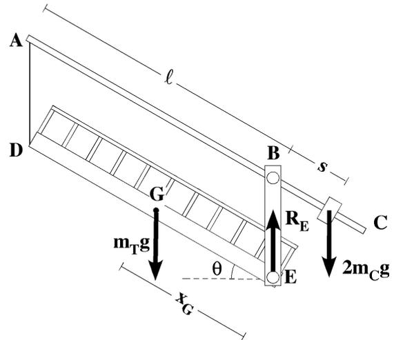
b) Para estudiar el movimiento cuando se han desplazado los contrapesos, analizamos por separado las vigas y el tablero, aunque tendrán la misma aceleración angular. Cada viga tiene un punto fijo en B y calculando momentos obtenemos:
