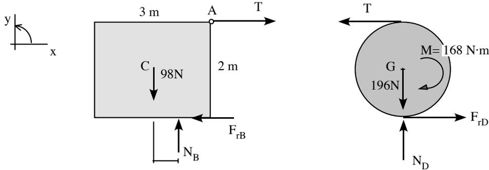
El bloque no vuelca, se traslada horizontalmente y todos sus puntos se mueven igual.
