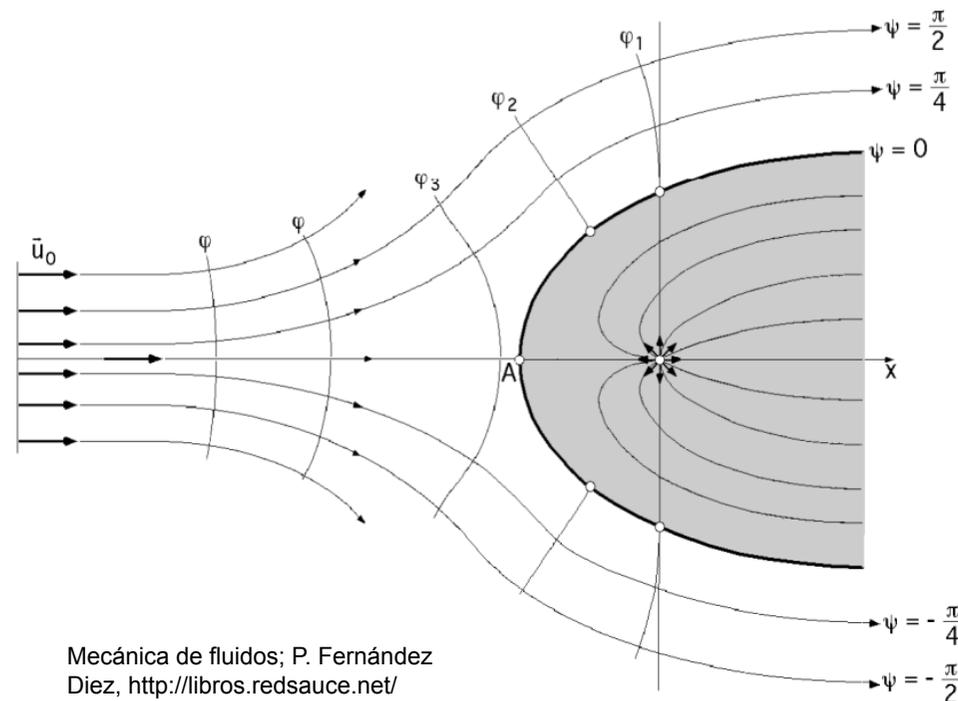
El semicuerpo de Rankine simula muy bien la parte frontal de un cuerpo cilíndrico Inmerso en una corriente fluida (pila de un puente).
