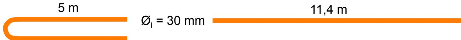
Tubería de  $\varnothing_i = 30 \text{ mm}$ , 10 m y un codo de  $180^\circ$
