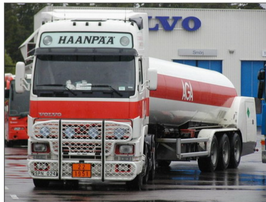
Transporte de argón líquido refrigerado.
