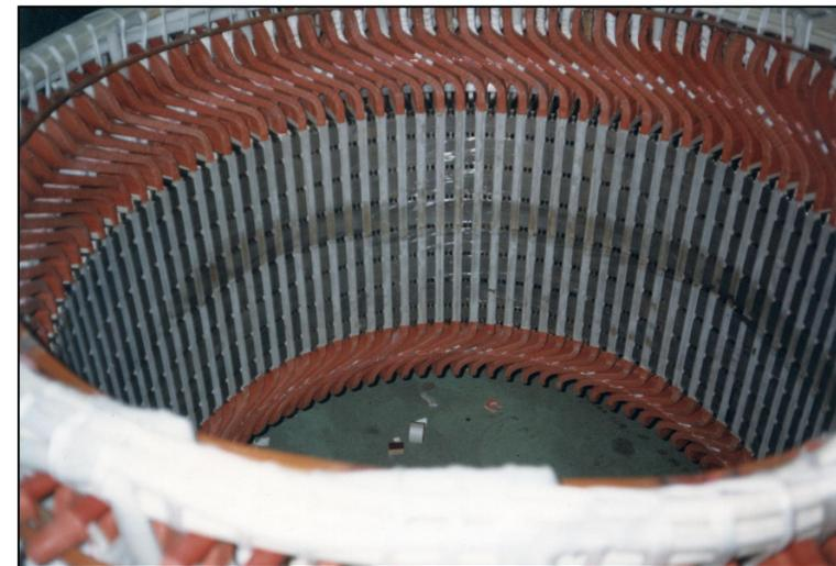
Estator de un alternador trifásico
