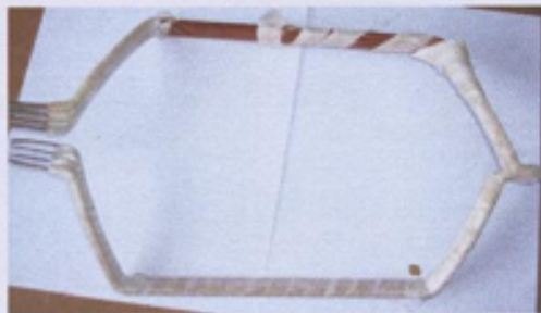
Fig. 13: Bobinas de un devanado de c.c. fabricadas con pletina de cobre de: a) una sección de dos espiras; b) cuatro secciones de una espira.
