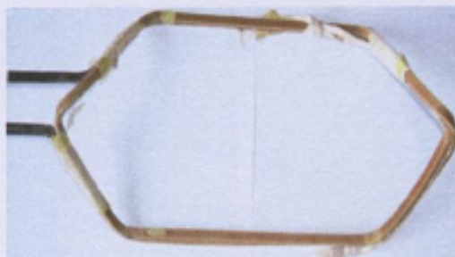
Fig. 13: Bobinas de un devanado de c.c. fabricadas con pletina de cobre de: a) una sección de dos espiras; b) cuatro secciones de una espira.
