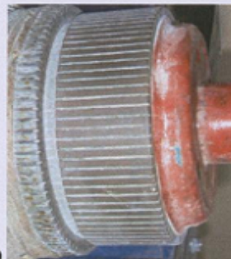
Fig. 6: a) Delga; b) y c) Colectores de delgas. (1: Superficie de contacto con las escobillas; 2: Talón para la conexión a las bobinas; 3: Cola de milano)
