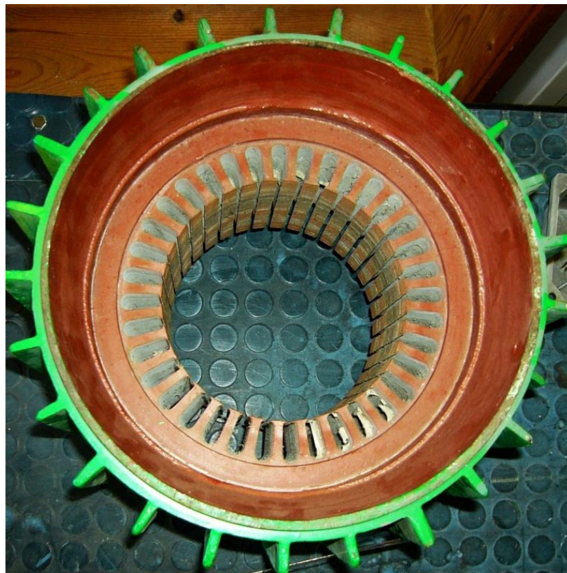
Fig. 6.10: Carcasa con aletas y núcleo magnético del estator construido apilando chapas magnéticas. En este circuito magnético obsérvense las ranuras donde se alojará el devanado del estator.
