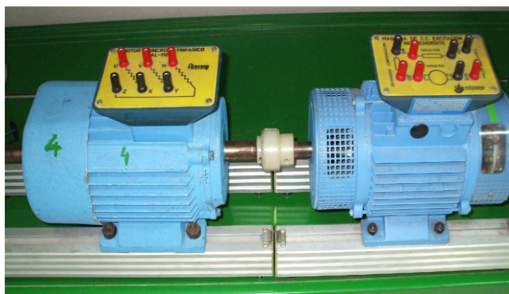
Fig. P0.4: Grupo de máquinas eléctricas sobre una bancada
