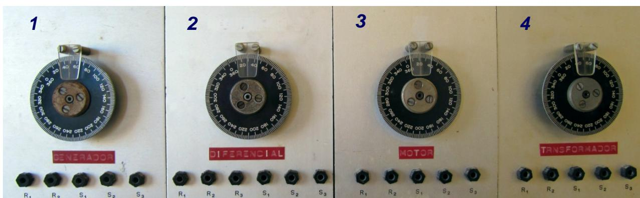
*Fig. 58: De izquierda a derecha estas son las fotos de unos sincros: 1: generador; 2: diferencial; 3: motor y 4: transformador.*
