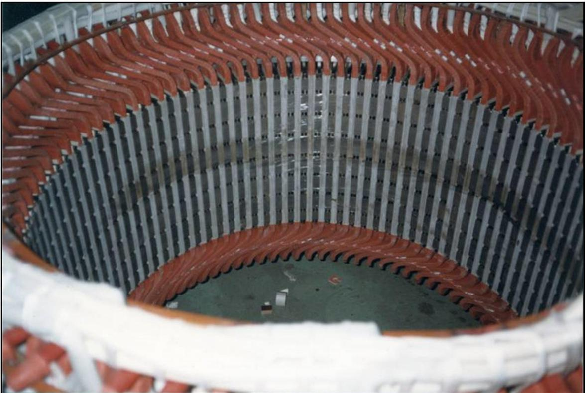
**Estator de un alternador trifásico**
