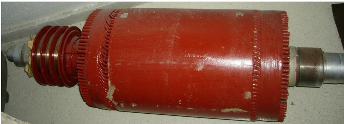
*Fig. 5: Rotor bobinado o con anillos*
