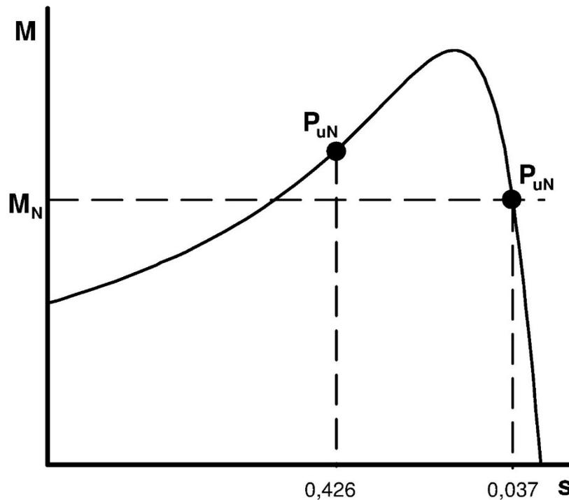
Si se representan estos dos puntos de funcionamiento sobre la curva del par (ver la figura adjunta) se observa que el primero corresponde a un funcionamiento como motor en la zona de bajos deslizamientos (zona usual de trabajo para este tipo de máquinas) y el otro corresponde a funcionamiento como motor con gran deslizamiento. Por lo tanto, la solución buscada es la primera.
