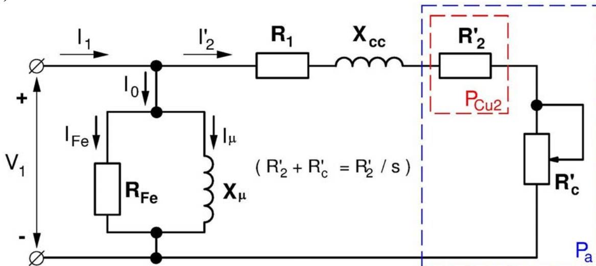
Recuerde que, según el circuito equivalente de un motor (ver la figura adjunta), se cumple que
