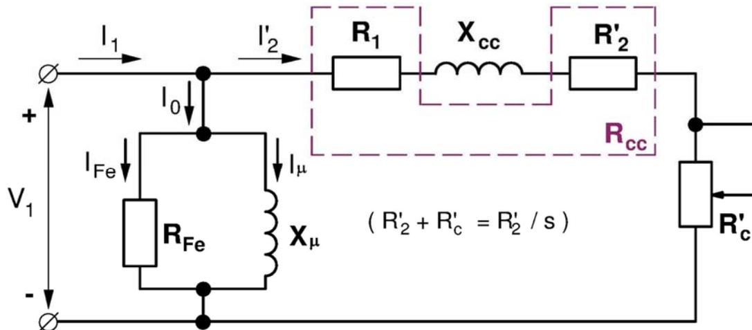
Durante el arranque la corriente del rotor reducida al estator es mucho mayor que la de vacío  $I_0$  y, por lo tanto, se desprecia esta última. Así, del circuito equivalente aproximado de un motor asíncrono (ver la figura) y sabiendo que en el arranque el deslizamiento vale la unidad ( $s = 1$ ) se obtiene que la intensidad de fase en un arranque vale:
