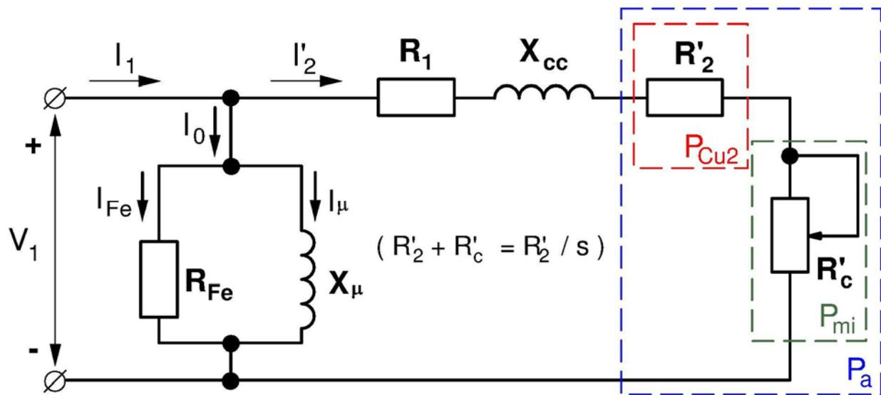
Utilizando la expresión anterior con los valores asignados de tensión (de fase), frecuencia y potencia útil se obtiene:
