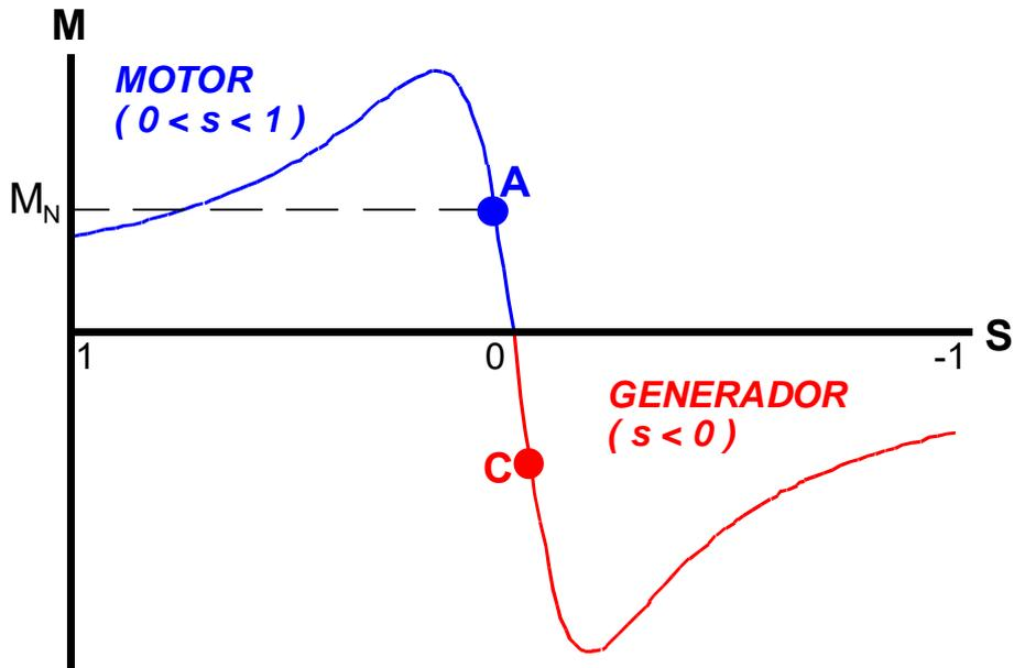
Fig. 3: Curva del par de una máquina asíncrona trifásica actuando como motor y como generador
