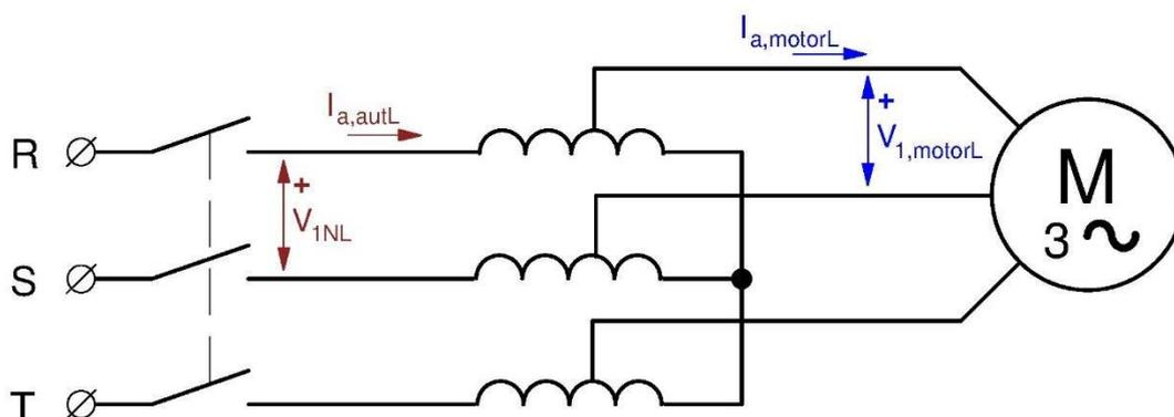
Fig. 2: Circuito para el arranque por autotransformador
