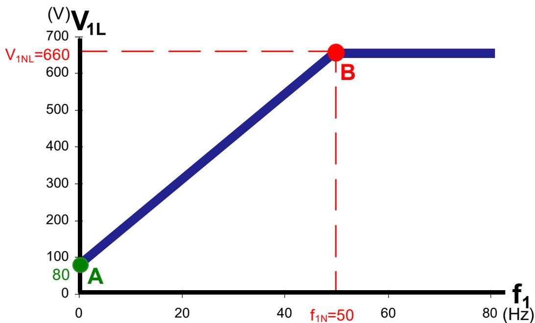
Fig. 2: Relación entre la tensión y la frecuencia en el variador de frecuencias
