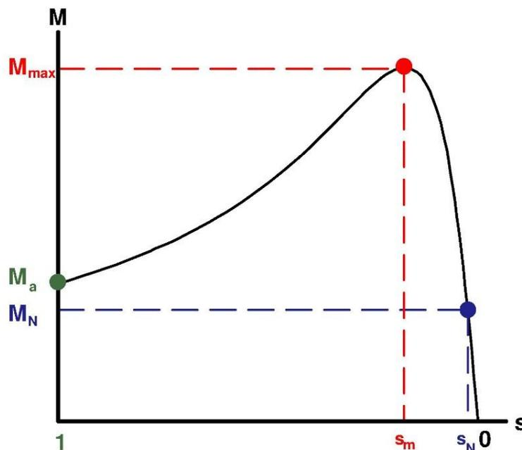
En la figura anterior se muestra la curva de par de un motor asíncrono trifásico. En ella se observa que el par máximo se produce para un deslizamiento  $s_m$  superior al deslizamiento asignado  $s_N$ ; luego la segunda de las dos soluciones obtenidas no es válida y el deslizamiento de par máximo vale  $s_m = 0,192$ .
