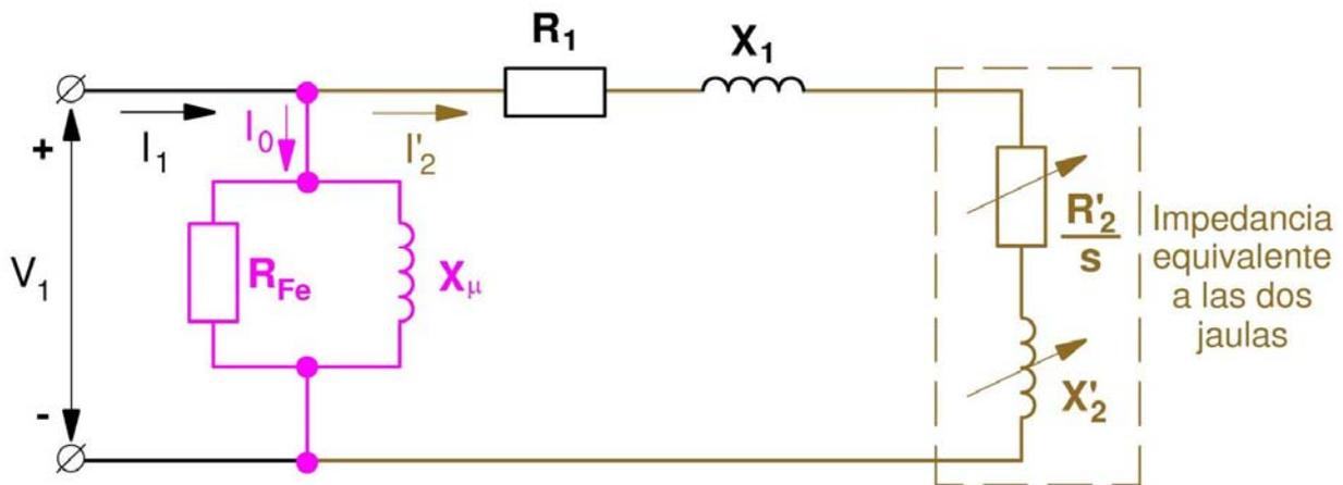
Fig. 4: Circuito equivalente de un motor de doble jaula con resistencia y reactancia del rotor variables con la frecuencia rotórica  $f_2$
