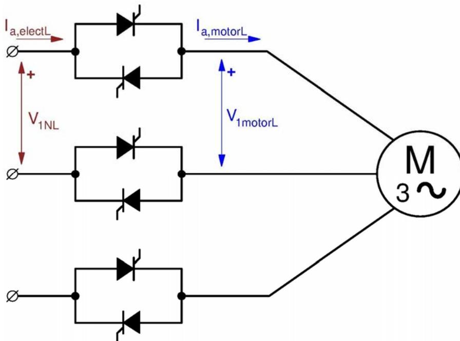
Fig. 3: Circuito para el arranque con un arrancador electrónico
