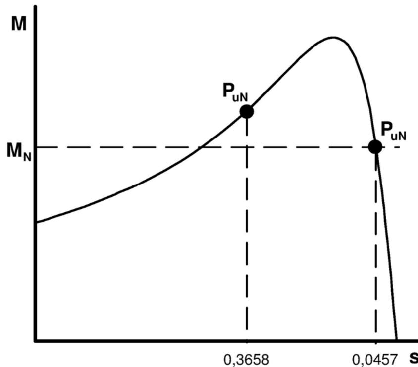
Si se representan sobre la curva del par estos los dos puntos de funcionamiento correspondientes a los dos valores de  $s_N$  obtenidos (ver la figura adjunta) se observa que el primero corresponde a un funcionamiento como motor en la zona de bajos deslizamientos (zona usual de trabajo para este tipo de máquinas) y el otro corresponde a funcionamiento como motor con gran deslizamiento. Por lo tanto, la solución buscada es la primera.
