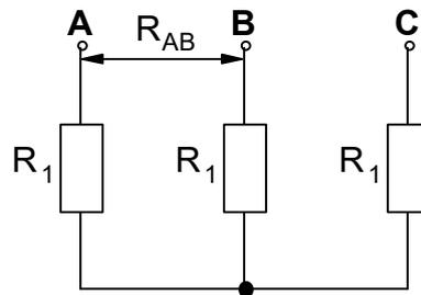
La resistencia medida entre dos de las fases de un devanado trifásico conectado en estrella (por ejemplo, la resistencia  $R_{AB}$  entre las fases A y B) es igual dos veces la resistencia  $R_1$  de una fase (ver la figura adjunta). En consecuencia, se obtiene que:
