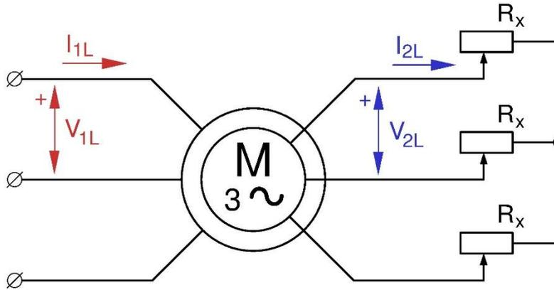
Fig. 5: Circuito para controlar la velocidad añadiendo resistencias en serie con el rotor
