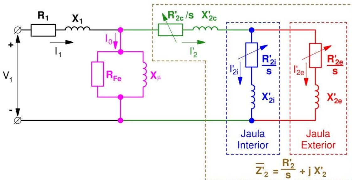
Fig. 1: Circuito equivalente de un motor asíncrono trifásico de doble jaula
