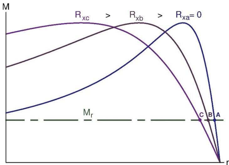
Fig. 6: Curvas de par de un motor asíncrono con resistencias en serie con el rotor
