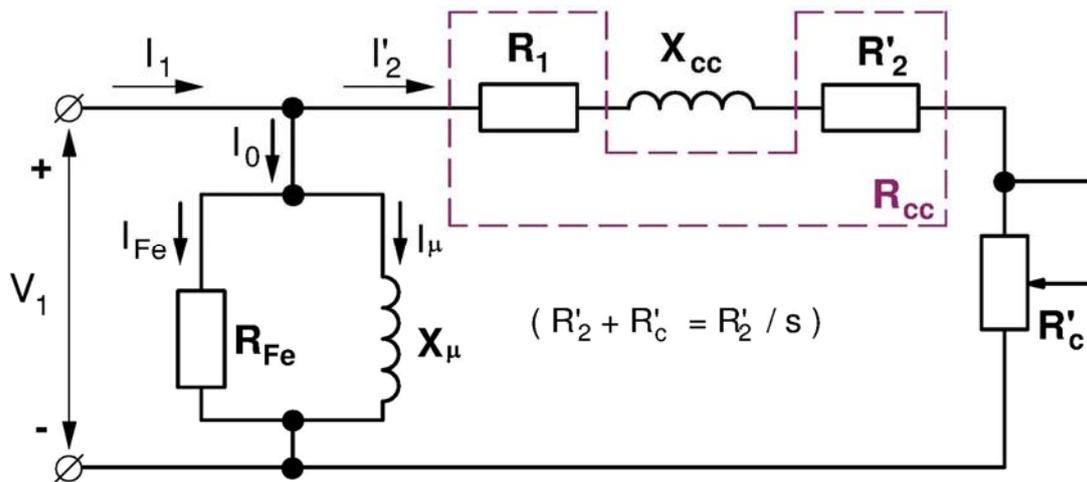
Fig. 1: Circuito equivalente aproximado de una máquina asíncrona trifásica
