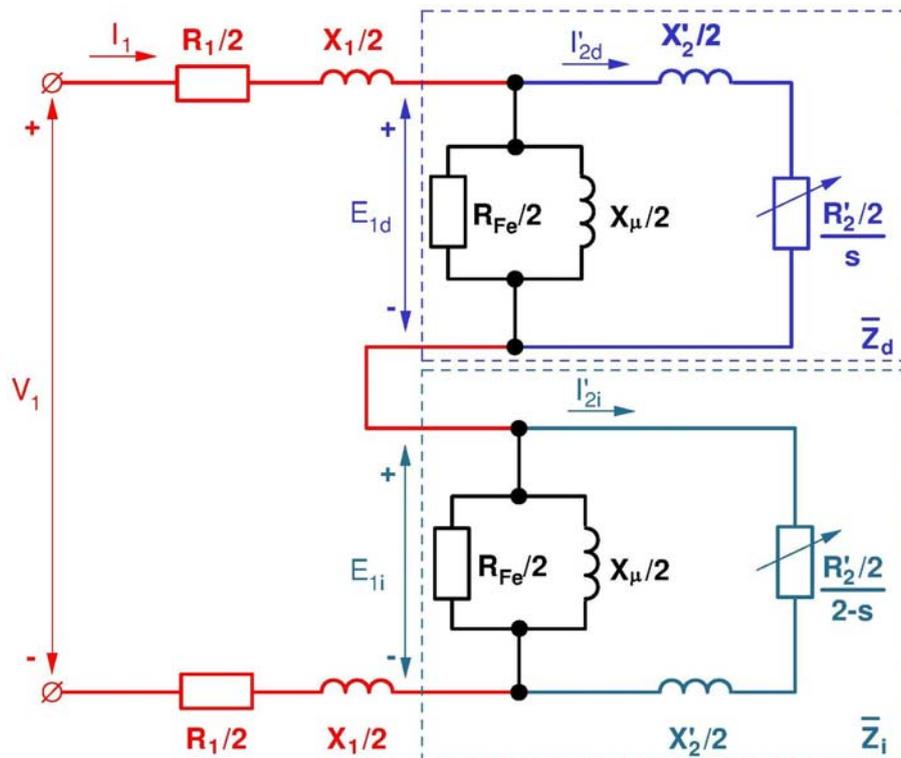
Fig. 1: Circuito equivalente de un motor asíncrono monofásico
