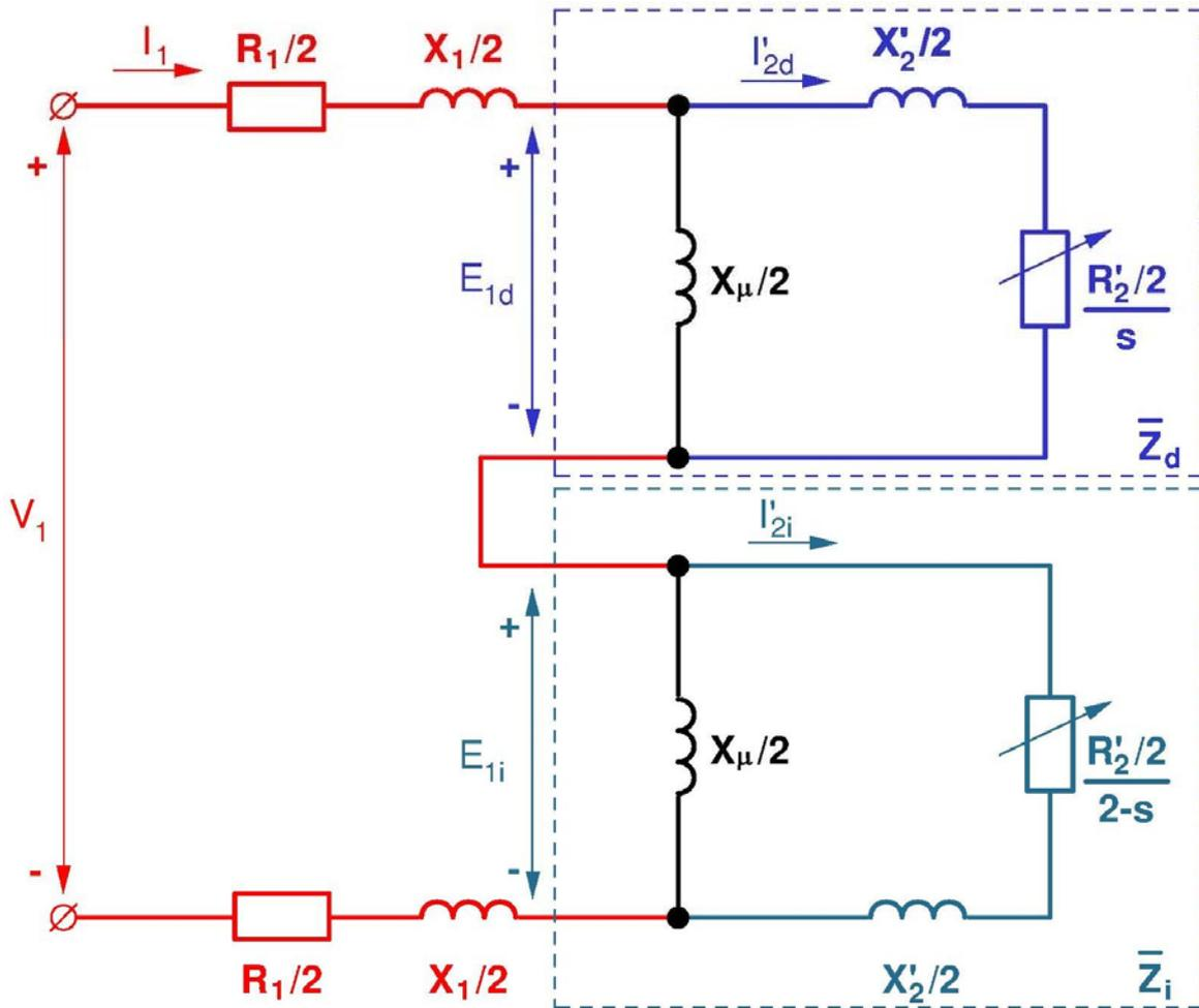
Fig. 2: Circuito equivalente simplificado de un motor asíncrono monofásico
