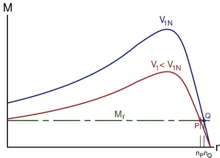
Fig. 4: Curvas de par de un motor asíncrono a dos tensiones diferentes
