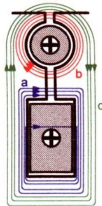
Fig. 2: *Dispersión en una ranura del rotor de un motor de doble jaula*
