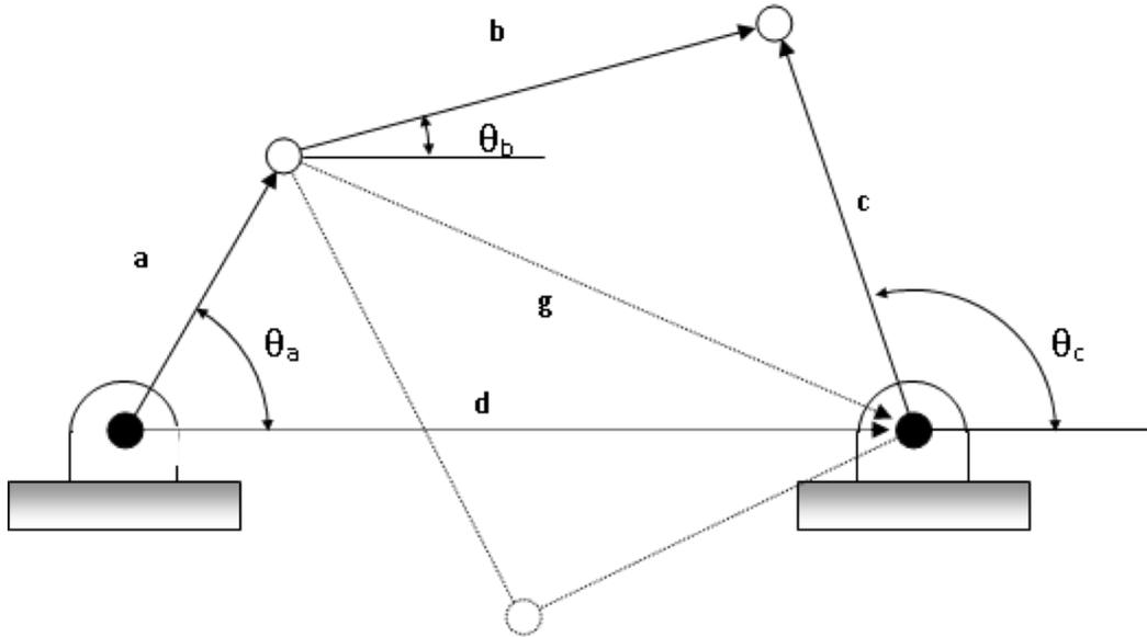
Ecuación de cierre:  $\vec{a} + \vec{b} = \vec{d} + \vec{c} \Rightarrow \vec{b} - \vec{c} = \vec{d} - \vec{a} = \vec{g}$  (Caso 4)
