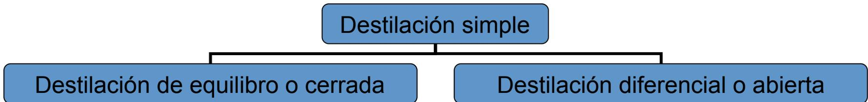
En el primer tipo, Destilación de equilibrio, se lleva la mezcla líquida hasta una temperatura intermedia entre la del principio y final de la ebullición, permitiendo que el vapor formado alcance un equilibrio con el líquido a esa temperatura
