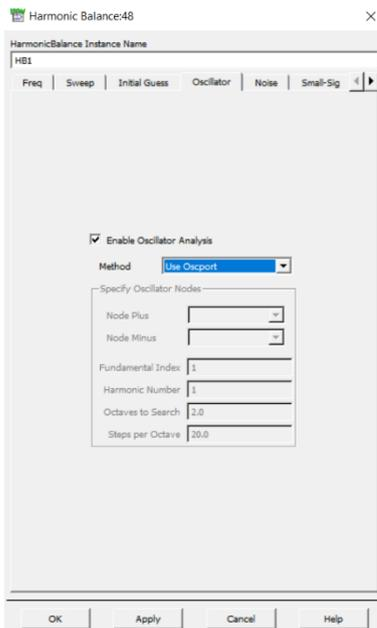
Debemos habilitar el modo “Análisis de oscilador” en el controlador de balance armónico y seleccionar el uso de la herramienta OscPort que habremos introducido en el terminal de gate como se muestra en el esquemático.
