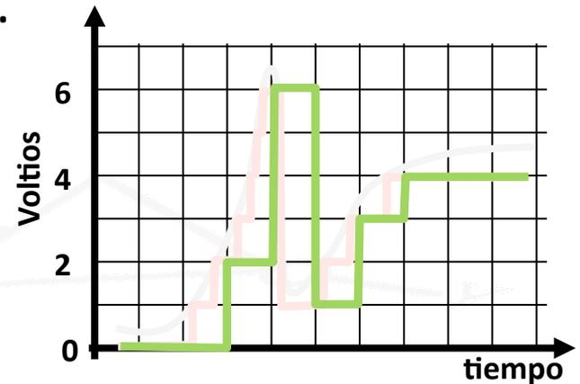
**Señal Digital Síncrona:** el voltaje solo varía en ciertos instantes de tiempo (cuando marca la señal de reloj).
